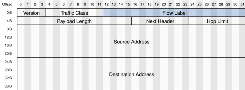
Abbildung 6: IPv6-Header (minimale Länge: 40 B, vgl. 20 B bei IPv4)
